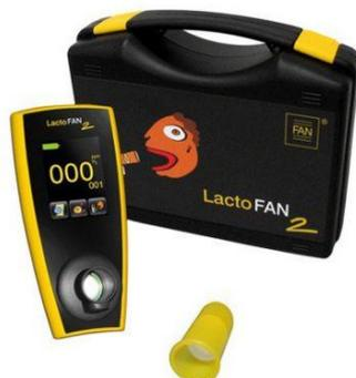
Il principio di funzionamento del LactoFAN2 si basa su una cella elettrochimica che agisce sfruttando la reazione dell'idrogeno con un elettrolita ad un elettrodo e l'ossigeno (presente nell'aria). Questa reazione genera una corrente elettrica proporzionale alla concentrazione di H<sub>2</sub>.
